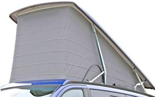
Los días de mucho frío o mucho calor o mucho ruido cercano podemos atenuar la falta de confort con respecto a la cama inferior añadiendo por la parte interior a la lona de fuelle un **set isotérmico** del mismo material *multicapa*
