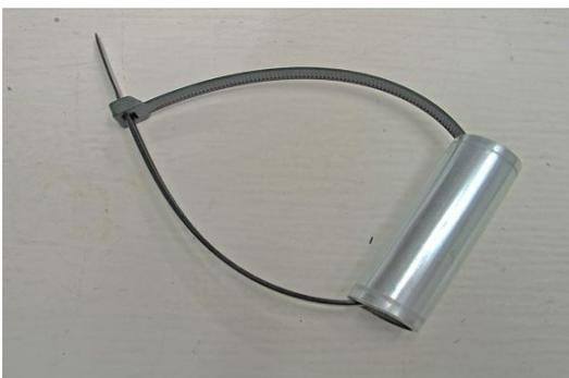
con el fin de que, cerrado el lazo por el lado interior del habitáculo, podamos tensar fuertemente la manguera para que se encastre en el taladro del chasis y a la vez **no se arranque** en caso de que algún mecánico tirara involuntariamente de ella desmontando alguna pieza en esa zona del motor.
