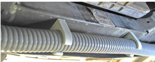
De este modo **evitaremos** exponer el tubo por **el lado interior del motor**, con temperaturas más elevadas y donde nos encontraríamos con problemas de desmontaje de otros elementos como el filtro de aire.
