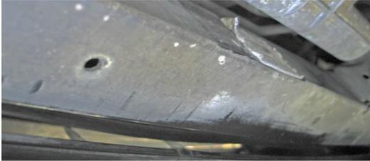
junto al cárter de aceite, para embutir dos **tuercas remachables** de aluminio de 5 mm  $\varnothing$ ,
