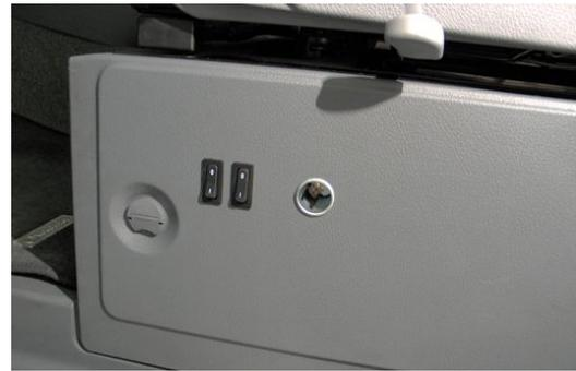
Como el **compartimento motor suele venir muy bien aislado** del salpicadero para no transmitir calor, vibraciones y ruido, los fabricantes dejan previstos pequeños orificios para ulteriores instalaciones.
