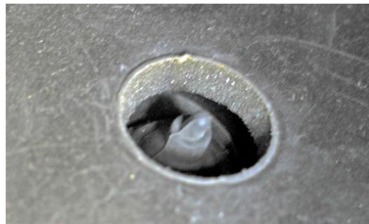
Retiraremos entonces el *tetón prensaestopas* para que nos quede al descubierto el orificio por el que ya podremos ver la luz que viene de la zona del motor.
