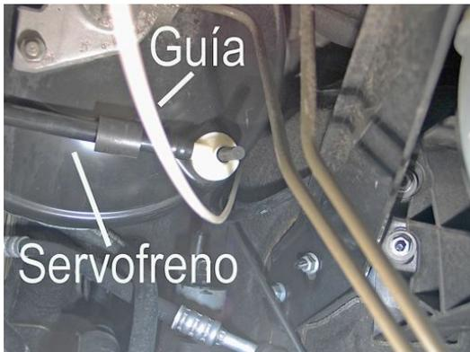
por donde empezaremos a instalar el **tubo anillado** o de *tráquea*. En este caso hemos elegido uno de PVC *autoextinguible* al fuego de 40 mm  $\varnothing$  con armadura **interior de acero** inviolable.
