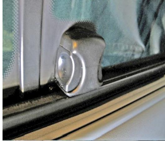
Por tanto, una manera interesante de bloquear el desplazamiento y evitar que nos las abran para entrar en la furgó sería **hacer unas piezas de madera, PVA o PVC** con la forma exacta del **carril** por el que se mueven.
