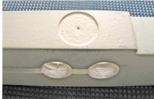
y un carril fresado para embutir los conductores y ocultarlos. **Si no tenemos fresadora**, podemos hacerlo con varias pasadas paralelas y próximas de la sierra circular con poca profundidad de corte.
