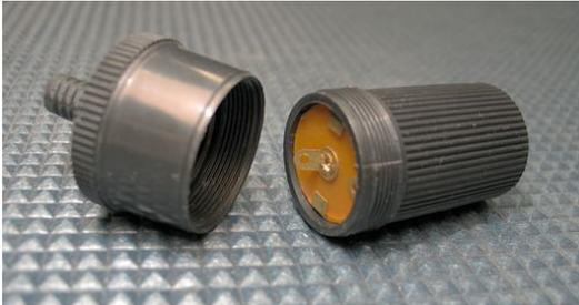
A continuación **soldar en paralelo** los contactos (positivo a los centrales y negativo a los laterales),
