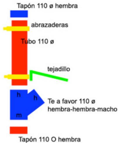
Extrapolando el concepto a un tubo de 110 mm Ø que nos dé una gran capacidad, podemos poner una sección vertical fijada a la pared con dos abrazaderas metálicas. Su parte superior se cierra con un *tapón ciego* hembra sin encolar que sólo levantaremos para añadir agua o pienso
