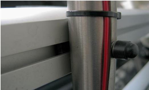
**hasta las nuevas luces de matrícula y extremo de carga**, entrando por los orificios de 8 mm  $\varnothing$  que hicimos en la chapa.
