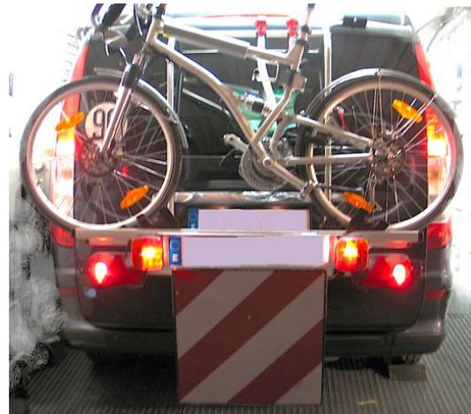
En lugar de llevar los cables para la luz roja de extremo de carga y para la tercera placa de matrícula, obligatorias de noche junto con la V20, **con bridas por fuera de los tubulares** del portabicicletas,
