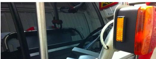
Para instalarlos, por ejemplo, en los laterales de las *ópticas de extremo de carga*, bastan dos pequeños taladros de 5 mm  $\varnothing$
