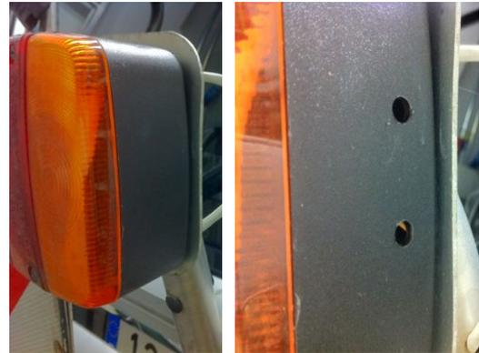
e insertar en ellos a presión los vástagos estriados de unos recambios de **catadióptricos de pedal de bicicleta** (éstos son Mercedes-Benz referencia **FA003650736 Pedalreflektoren 1 Satz**).
