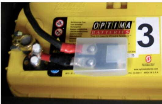
y revestir con una tortita de **plastilina roja** los tornillos exteriores con polaridad positiva.
