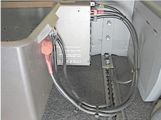
Finalmente se introduce la tercera batería en su hueco, que está sobredimensionado por si en otro momento se desea cambiar por una de mayor capacidad, por ejemplo, una de 100 ó 150 Ah.
