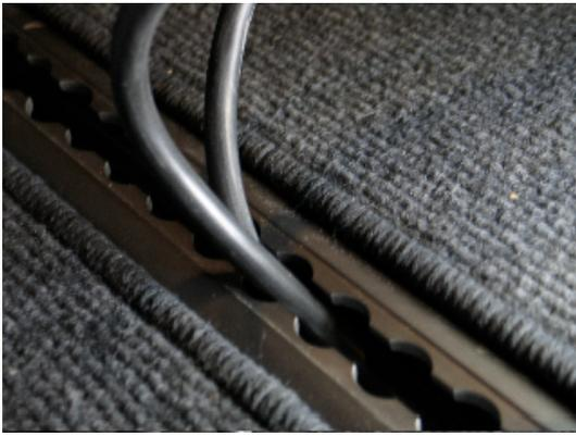
metemos todos los vástagos que van a trabajar como **bornas** en los agujeros de la caja y los cableamos y protegemos con un segmento de manguera de goma con el color identificativo de su polaridad (forrándola con cinta aislante) según esta **secuencia**, que es idéntica en todas las conexiones, con la cabeza por fuera y la tuerca por dentro.
