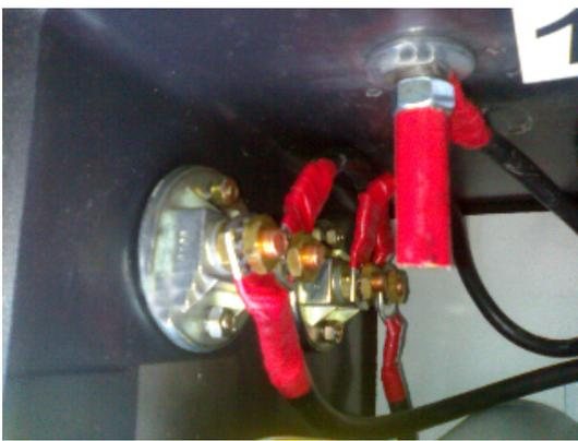
para terminar después con el **negativo**, que en realidad es sólo unir las bornas negativas a masa y entre sí. Y rotulamos cada *puerto* de entrada de las dos primeras baterías con sus números. No hay que olvidar aquella máxima que dice que *una cosa está bien ordenada cuando cualquier otro distinto de nosotros es capaz de encontrar algo rápidamente*. Así evitaremos confusiones en el futuro.
