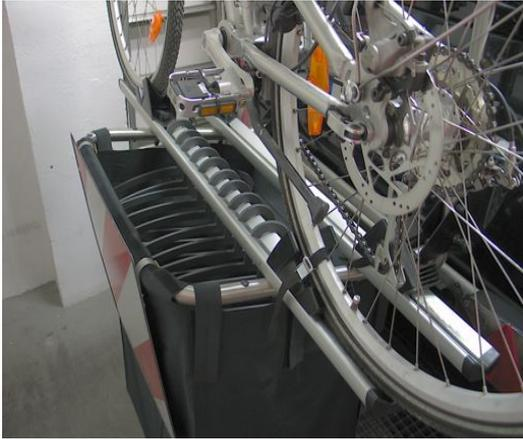
y no interfiere en la colocación de la placa V20. Y **aprovecha el espacio entre las ruedas de las bicis.**
