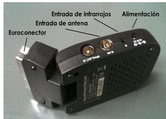
Por un lado recibe **5 V de corriente continua** que podemos suministrarle con el adaptador 220 V AC > 5 V CC que incluye el pack (necesitaremos tener inversor) o bien con otro transformador (otros 9 €) como el de la foto de arriba, pero ajustado a 5 V mediante la **palanca selectora**. Nosotros hemos preferido esta opción
