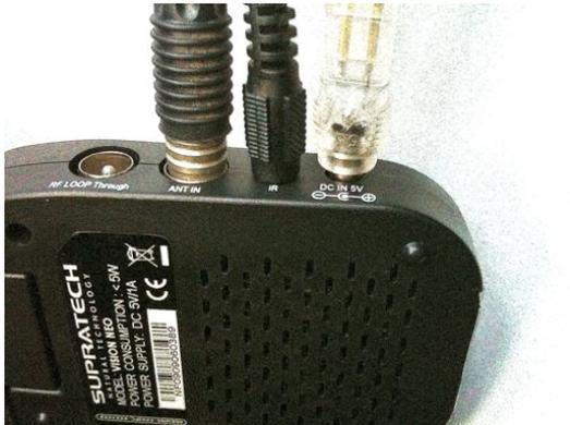
Al lado lleva la entrada de la **señal de infrarrojos (IR)** para actuar con el **mando a distancia**. El extremo del diodo receptor lo pondremos en un sitio que nos resulte cómodo para apuntar.
