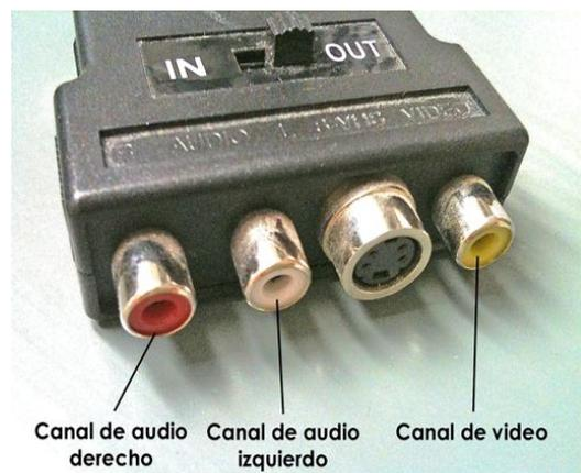
Y nada más: sólo hay que ensartar todas las piezas y conectarlas mediante el alargador **RCA macho-macho** con el viejo sintonizador
