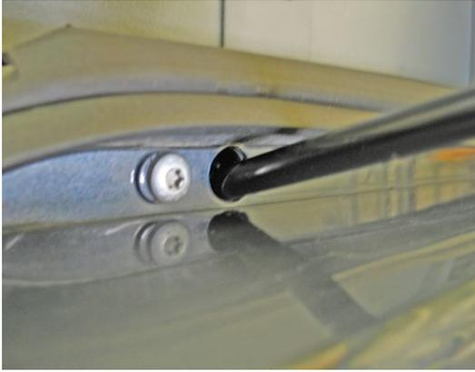
el **vástago largo A 639 583 00 45** que viene suministrado junto a la herramienta del gato y accionarlo mediante la **carraca 414 581 00 49**,
