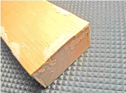
y luego meter la pieza entera por inmersión en un baño de **tapaporos nitrocelulósico** o bien en **selladora sintética** blanca. Así será más rápido y efectivo el preparado de las superficies.
