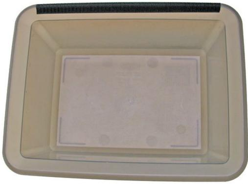
Para que no se muevan durante la marcha, cosa que es especialmente útil y segura en el lado del conductor, **se pega un velcro macho autoadhesivo** en uno de los cantos. La propia moqueta del suelo hace de velcro hembra.
