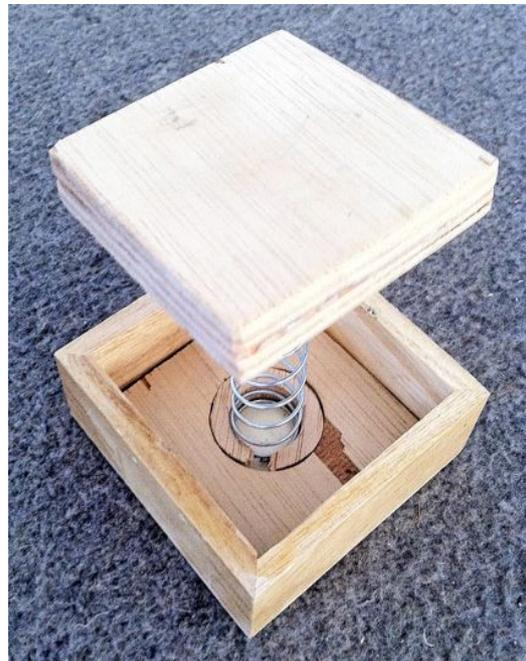
Con masilla *bicomponente* para soldadura en frío, versión especial para madera, **anclamos bien las dos conteras del resorte**,
