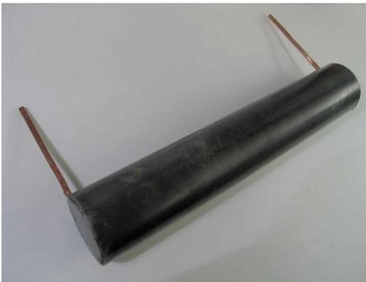
adaptamos los dos **extremos del serpentín** para que sean capaces de acoplarse a su entrada y salida de agua:
