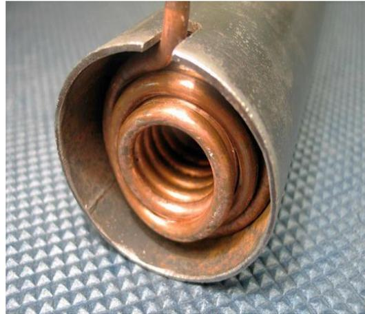
El hecho de que sea de hierro, gran conductor del calor como el cobre, nos proporcionará **mejor inercia térmica** al aparato: es decir, el agua estará durante muchos segundos circulando dentro de un recinto muy caliente y que tiende a mantenerse caliente por la masa metálica total sometida a calor.
