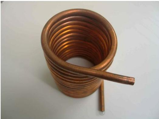
Para que el conjunto serpentín, algo maleable, quede compacto, unitario y rígido, es preciso **encapsularlo en un cilindro** de hierro dulce que podemos recortar de un tubo de 65 mm  $\varnothing$  interior aproximadamente.
