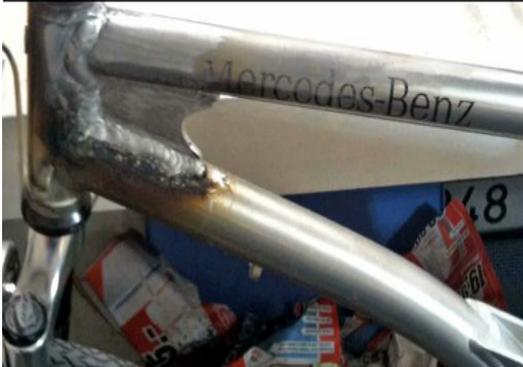
Una vez enfrizada la soldadura se *amol*an las grandes imperfecciones a máquina y con una lima fina. Se termina **aplicando sucesivamente hojas de lija** de grano más fino cada vez (60-120-240-400) hasta que resulte muy suave al tacto.
