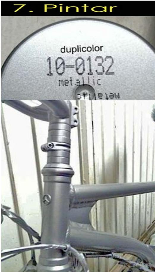
para rociar **dos o tres capas**, según la necesidad, en un ambiente completamente desprovisto de polvo y corrientes de aire, dejando secar entre ellas.
