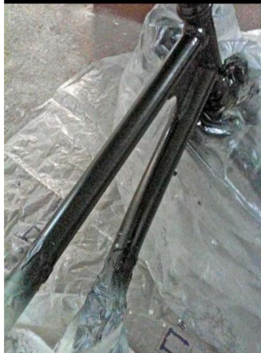
Para la capa de imprimación usaremos al menos dos capas de un **spray de aparejo** que uniformen los poros del material y prepare la adherencia de la pintura.
