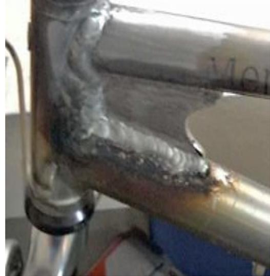
En este caso concreto, es mucho mejor realizar la soldadura con la tija del manillar en su lugar original, **sin sacarla**, para evitar deformaciones por calor en el tubo.
