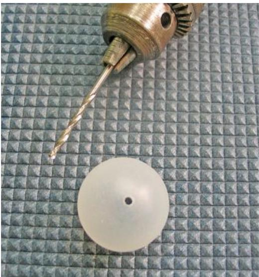
El grande sirve para que nos quepan bien un par de arandelas y un tornillo de *rosca-chapa* para **hacer solidaria la bola al cuerpo del espejo ya recortado.**
