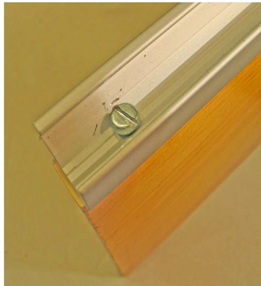
La única precaución que hay que tener es **cortar la cara que ha de entrar en contacto con la pieza de aluminio a 10° de inclinación** para que, una vez colocada en el larguero de la encimera quede perfectamente horizontal una vez se asiente en su posición y/o reciba el peso de lo que se le ponga encima (unos **10 Kg** como máximo).
