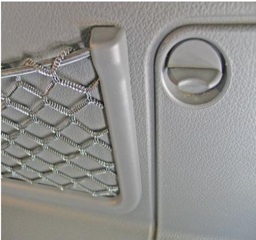
Debemos respetar la ubicación del **portainterruptor** que, aunque en las *Marco Polo* va ciego porque es específico del acabado *Ambiente* para accionar eléctricamente la ventanilla deflectora trasera, siempre nos puede servir más adelante para poner el control de algún aparato posterior con un interruptor *Westfalia*.
