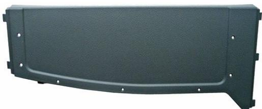
Para retirar la red y su bastidor, lo primero que se hace es fijarse que **por el dorso van unidos mediante unas presillas de araña** que sujetan los vástagos del bastidor al revestimiento.
