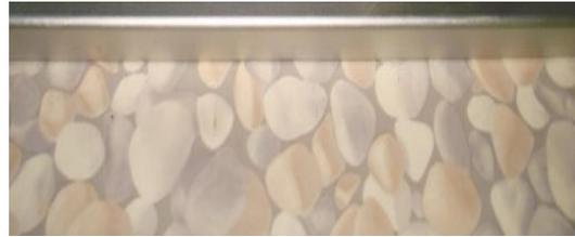
El carrocerero *Westfalia* incorpora esas piezas **simplemente pegadas** y se pueden arrancar en unos minutos sin deteriorar nada con apenas ir introduciendo con cuidado un destornillador estrecho y de **vástago muy largo** para hacer palanca sin rebasar un ángulo de unos 10°.
