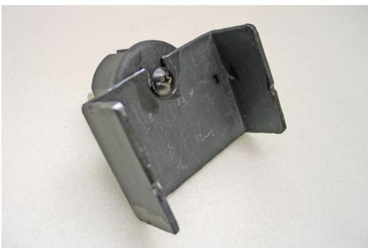
de manera que, enchufando el *inventillo* en la toma de la trasera del asiento del conductor, tengamos un sencillo soporte para los triángulos.
