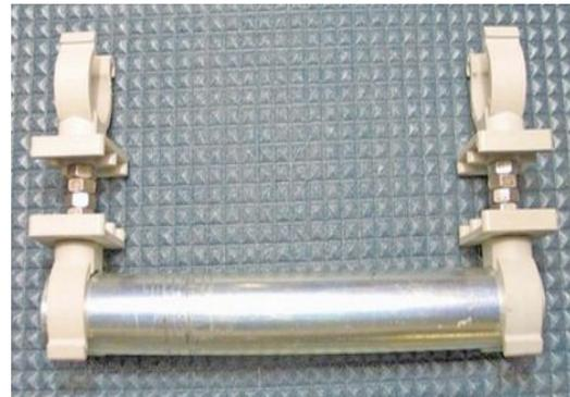
Esa separación la hacemos, por ejemplo, **intercalando tuercas** o arandelas, y la carenamos con la versátil masilla *Arregladoto Pattex* dejando un poco de exceso,
