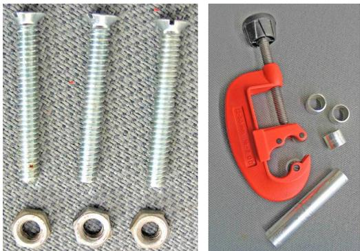
fijarlo al carril de aluminio haciéndole la forma con unos pequeños **recortes de tubo de acero** de 20 mm  $\varnothing$  que creamos con un cortador de fontanería.
