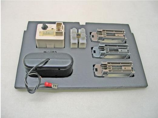
Se unen las **conexiones eléctricas** necesarias partiendo de la regleta, sin olvidar, claro está, ajustar el cable que viene de la caja de fusibles en ella respetando la polaridad antes de posar definitivamente el conjunto en la balda superior del armario con un poco también de cinta adhesiva de doble cara que impedirá que ceda la placa al enchufarle consumidores o manipular los mecanismos.
