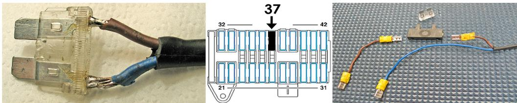
No olvides dejar protegida de nuevo la instalación con un fusible igual al retirado usando un **portafusibles aéreo**.
