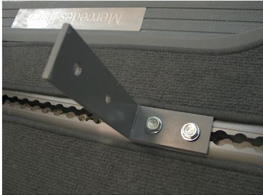
Suponen el apoyo más importante porque, debido a las fuerzas generadas por la marcha, son las que reciben la mayor parte del empuje de la estructura. Se han dispuesto con esquema de deformación hacia adelante y en posición oculta a la vista dentro del nuevo maletero. Se emplean tornillos de rosca métrica de 12 mm de diámetro. El mínimo que se exige en las homologaciones es 8 mm.
