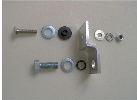
Para acoplar definitivamente el módulo a sus **tres fijaciones**, se emplean estos herrajes: tornillos de husillo de 12x55 mm, arandelas de ala media y tuercas con freno de plástico para evitar el afloje por vibración, como sigue:
