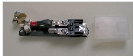
al positivo de la batería principal mediante un hilo de 25 mm<sup>2</sup> pasado a través del carril del piso.
