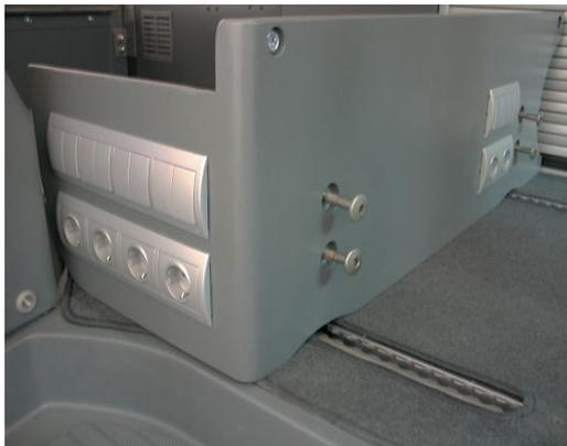
Por el lado interior se cierran con tuercas y arandelas *Grower* (ya sabéis: ésas que vienen partidas y desalineadas) para que no se aflojen.
