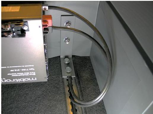
y el positivo de la batería a la *borna* positiva del inversor con la precaución de interponer en serie antes de la entrada un **maxifusible de 80 A** enfundado.
