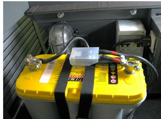
Con el fin de evitar contactos directos entre las bornas o sus conexiones (por ejemplo, si se cae un llavero, una cadena o una herramienta metálica), se protege todo el entorno del polo positivo con un tupper de todo a un euro puesto boca abajo.
