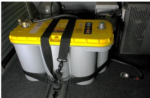
Después se termina de embornar el positivo al fusible y éste al hilo que procede del positivo de la batería principal a través del carril del suelo, y el negativo al desconectador estanco.
