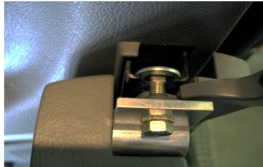
Se remata este módulo fijando el ángulo de apoyo con sus cuatro tornillos
