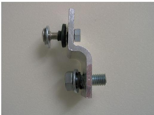
según esta disposición haciéndola solidaria a la pieza de DM con un tornillo de 12x40 mm que expandirá el taco metálico de 15 mm de diámetro alojado en su interior:
