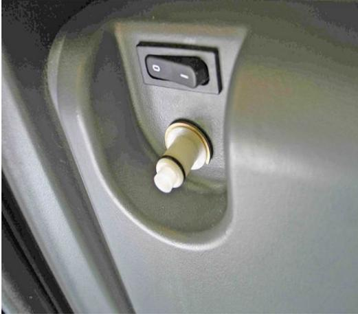
Es decir, **aunque el circuito esté bajo presión** de la bomba, que se conecta indistintamente desde el interruptor automático del grifo delantero como desde el manual que hay sobre el propio *macho*, **no sale agua si esta hembra del flexo no está acoplada** completamente.
