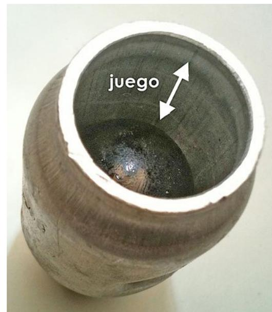
Si no existiera el racor **al dejar de aspirar perderíamos todo el trabajo** y el líquido volvería al vaso en el caso de no haber superado la cota requerida.
