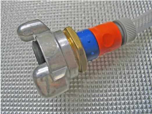
Y luego, si fuera necesario usar el de 70 mm  $\varnothing$ , ponerlo en serie con un **entronque reductor** de 45 a 70.
