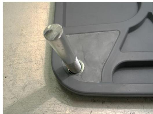
lo que vamos a hacer es insertar este vástago en los tubos de acero hueco mediante la **interposición de una manguera** de goma de 75 mm de largo que tenga como  $\varnothing$  exterior 23 mm e interior 16 mm. Así todo irá a presión y el ensamblaje será sencillo.
