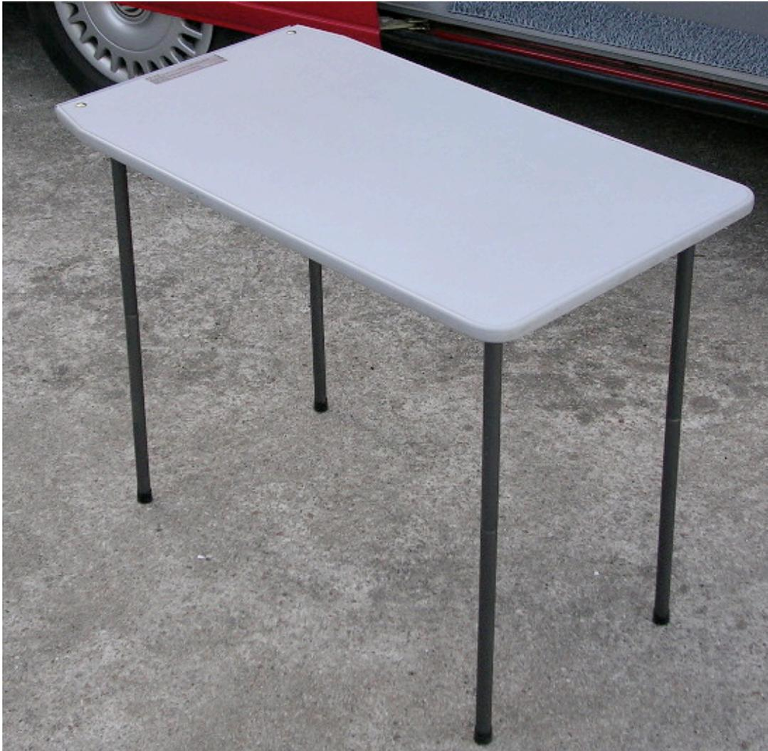
A nosotros nos interesa partir desde el arranque de la pata con un ángulo de unos  **$15^\circ$  divergentes del centro** de gravedad de la mesa, digamos coloquialmente *despatarrada*. Ampliaremos así la separación de apoyo
