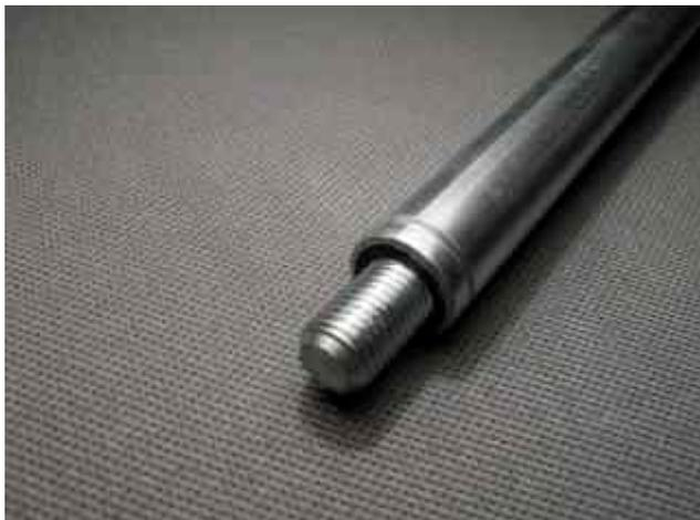
Va a bastante presión, pero si queremos asegurarnos de que el grupo *tornillo-manguera* **no se sale con el tiempo** del tubo metálico, basta practicarle en el tornillo de banco un taladro a 5 cm del borde y de 10 mm de profundidad y ajustarle un tornillo de *rosca-chapa* que después seccionamos y limamos.
