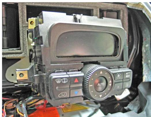
Lo mejor es **extraer el bloque** de mando del climatizador de la pieza de plástico en la que va inserto, a pesar de que no es necesario porque tiene mucho *juego* de movimientos.
