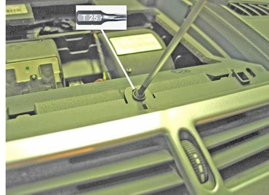
como cuatro tornillos (dos por lado) que encontraremos mirando con una linterna **dentro de los aireadores** centrales.
