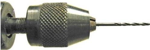
que cuidaremos de no partir con brusquedades, colocada en un **mandril pequeño** (los estándar suelen tolerar normalmente de 3 mm  $\varnothing$  en adelante), como por ejemplo éste de un **árbol flexible** de prolongación.
