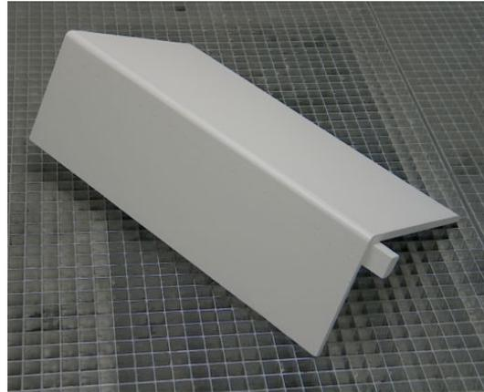
se refuerzan por el centro con un **listón cuadrado** que, además, nos servirá de pata para ventilar el interior del mueble, y se hacen **dos solapas**, una saliendo del mueble (se ve a la izquierda)
