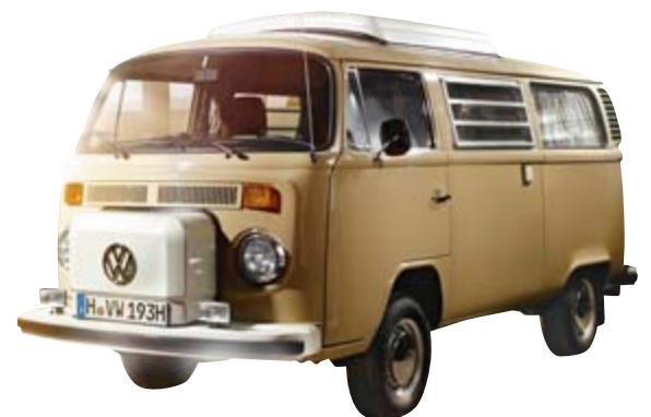
CAMBIO DE CARROCERÍA. Un diseño de la segunda generación, que alberga la rueda de repuesto en la parte delantera del vehículo.
