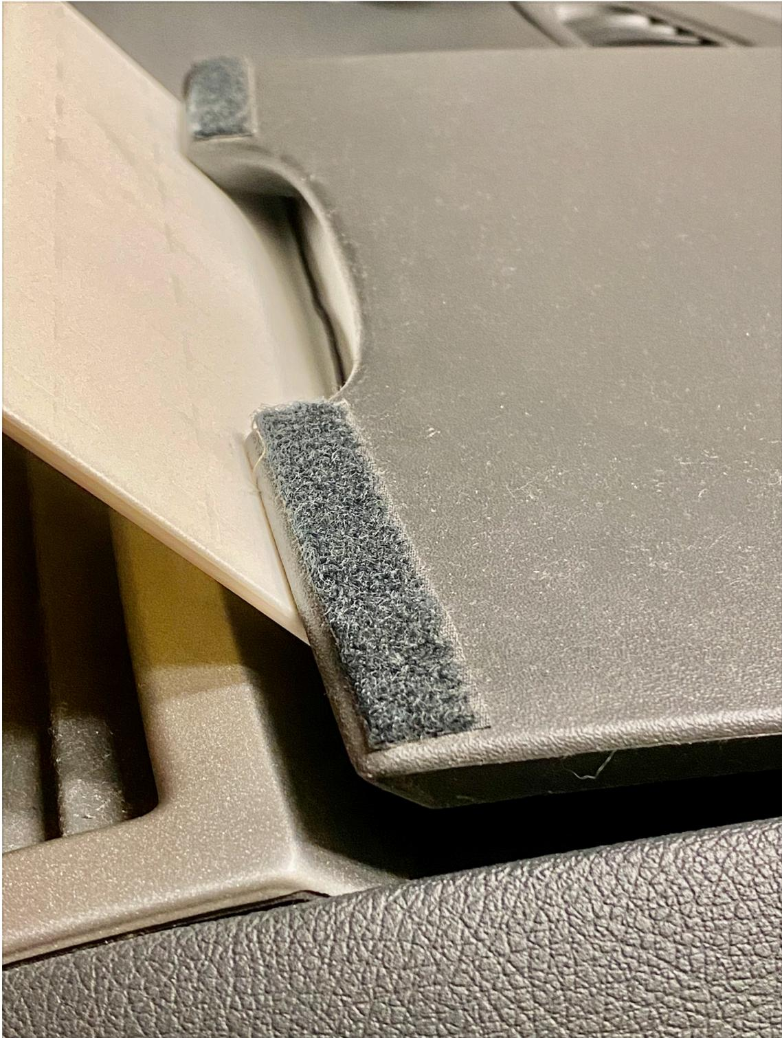
Para que podamos **seguir utilizando las teclas del climatizador y las luces de emergencia**, el apoyo de la superficie interior del atril se dota de dos **tacos**
