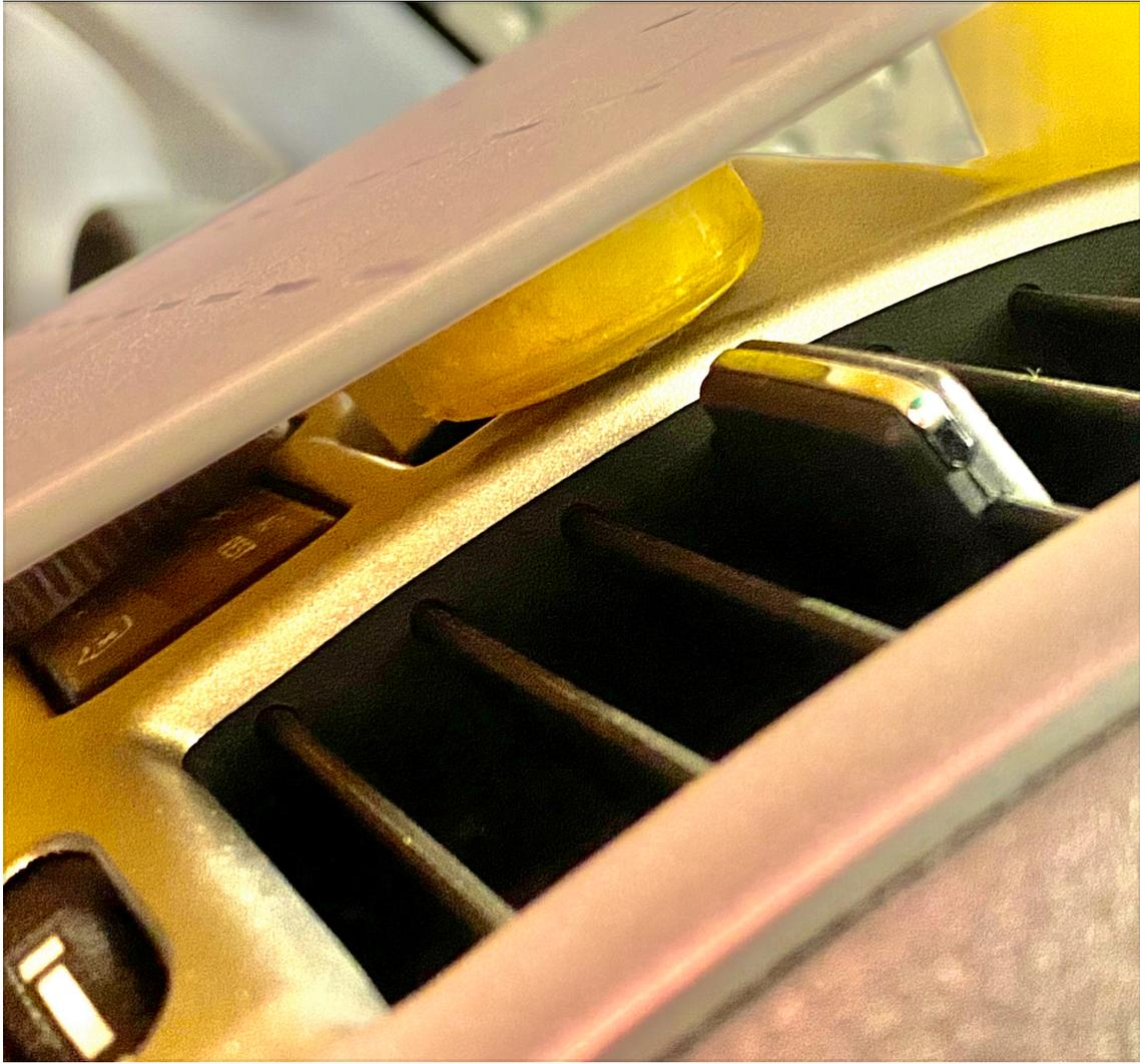
No obstante, al ser un cable el que retiene al atril, **funciona también como bisagra** y la estructura puede **bascular fácilmente hacia arriba** para operar mejor las teclas o ver la pantalla del climatizador. Si la soltamos, **baja por gravedad**.
