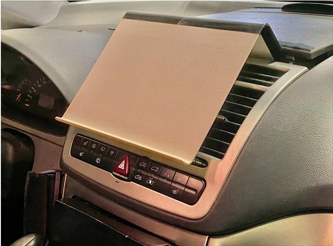
Por último, para que la sujeción de la tableta sea robusta, se pasa por debajo una **cinta elástica de doble garra** (en Amazon podéis encontrar modelos > **como éste**) que agarra por ambos lados a la tableta a la vez que no tapa los altavoces ni impide conectar el cable de carga o los periféricos.
