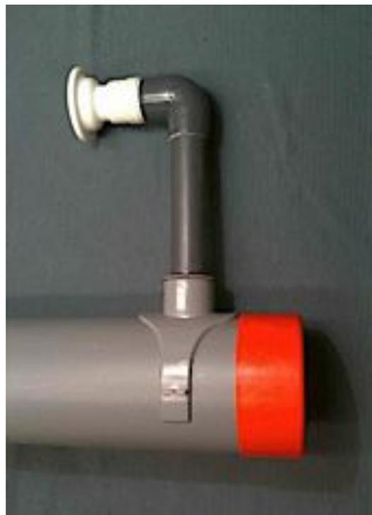
Para evitar fracturas y desajustes, **se arriestra todo con las dos abrazaderas bien unidas con una varilla roscada**; o, como en este caso, con dos empalmadas por *tuerca-manguito*.
