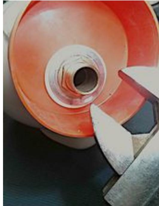
Para garantizar la estabilidad de la jara sobre el tapón, añadimos por detrás una **cuña de masilla bicomponente**
