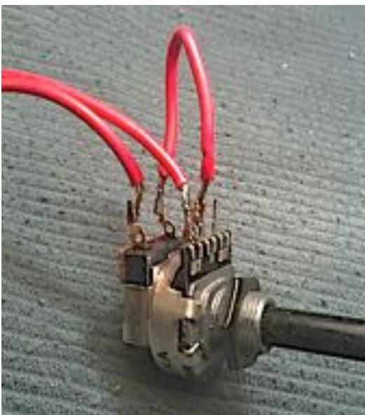
Con algo más de **medio metro de cable paralelo de 1 mm<sup>2</sup>** tendremos suficiente para las conexiones.
