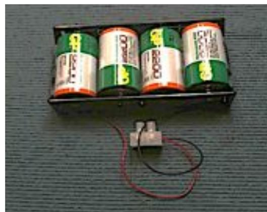
Una **resistencia variable de unos 1000 ohmios y unos 3 amperios**. Las más normales, como ésta, traen las dos patillas de atrás como interruptor y la central y una de las laterales como resistencia. Así podremos regular un poco el caudal del agua.
