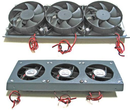
Para ello se usan los tornillos de 3 x 30 mm en todos los taladros **menos en los dos inferiores** del ventilador central, que serán de 4 x 40 mm con el fin de que, sin añadir ningún otro elemento, como por ejemplo una regleta de empalme, ellos mismos nos sirvan **a la vez como anclaje y como bornas** para recibir la corriente y empalmar los tres motores entre sí.
