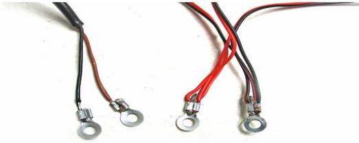
Montados todos ellos, **respetando la polaridad**, en los tornillos largos, se aseguran con las arandelas y las tuercas, para terminar **aislando cada polo** con su color en cinta aislante.
