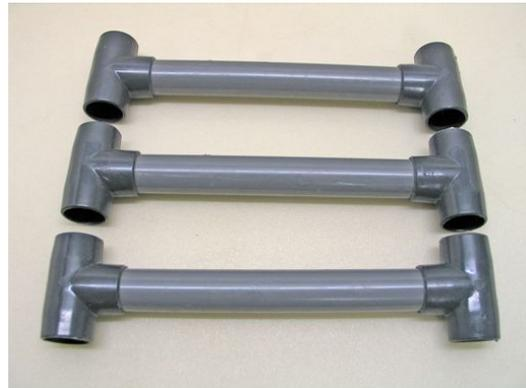
Para acabar, se insertan por la parte de abajo las de 0.21 m con sus dos taponos y por arriba las que nos quedan de 0.35 m con los otros dos taponos restantes.
