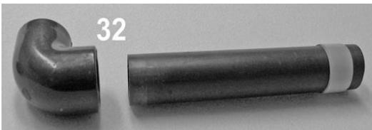
Luego se emboquilla un **codo hembra-hembra de 32 mm  $\varnothing$**  al extremo contrario para continuar la construcción de la pieza.
