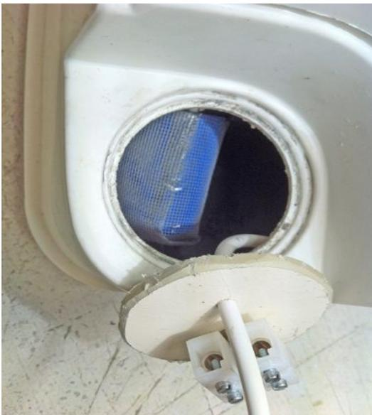
de forma que **la entrada de la bomba quede en la parte más baja posible** y así recoja el agua prácticamente hasta el vaciado del depósito. No hay que olvidar la doble brida *antitracción*.
