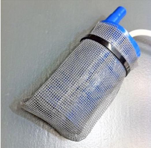
También le aseguramos con una abrazadera una **manguera de unos 30 cm de largo** y con un diámetro exterior ligeramente inferior al interior del tubo de tráquea (5) donde irá insertada.
