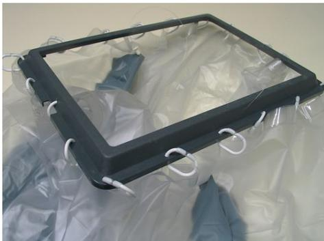
Hay que tener la precaución de cortar de una manguera transparente finita (de diámetro interior similar al del exterior de las anillas) tantas piezas de unos 4 cm de longitud como anillas. A continuación de meter las anillas en las cortinas y en el soporte *cortinero* se introducen estos *canutitos* transparentes por los extremos de las anillas forzándoles un poco la apertura
