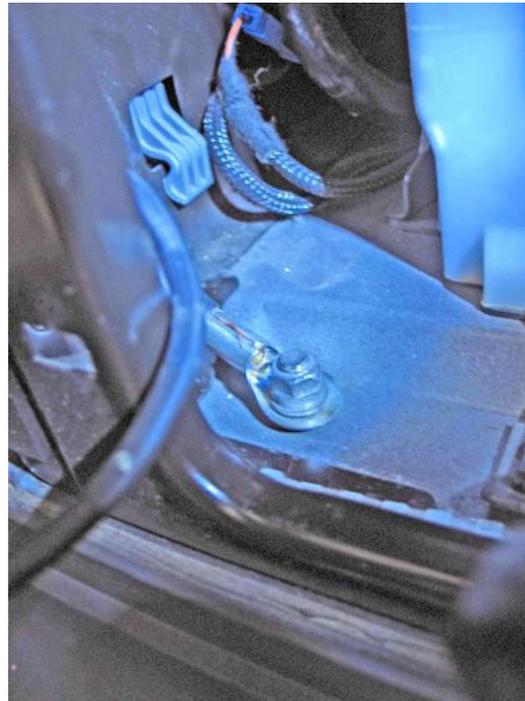
**Tiramos hacia nosotros** del bloque de la batería para operar con más facilidad e insertamos en la **borna** desnuda una **abrazadera nueva de latón**, teniendo la precaución de escoger una **de brazo largo**.
