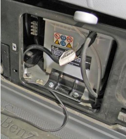
Para acometer este trabajo basta **aflojar** primeramente el **retén** de inercias que mantiene la batería fija en sus carriles (llave del número 10 para las Mercedes-Benz Viano)
