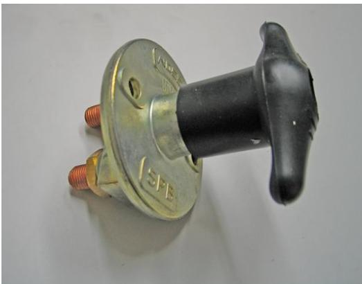
y los **de tornillo**, que se montan en un simple agujero con mucha facilidad, son más baratos, pero pueden producir chispas nada beneficiosas en caso de acumulación de gases mal drenados de la propia batería o de nuestra instalación de gas butano.
