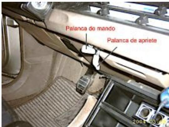
Sólo un pequeño **orificio en la moldura debajo del volante** nos basta para pasar el cable hasta la *contrapalanca* o **peineta** del acelerador. Allí la fijamos haciendo un lazo enhebrado en una regleta gruesa de empalmes eléctricos para que no se nos suelte.
