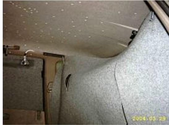
La cortina tiene **dos cortes paralelos rectos** terminados en círculo a la altura del espacio entre asientos para que podamos entrar cómodamente de la parte delantera a la trasera sin necesidad de retirar toda la pieza. El corte empieza abajo y termina unos centímetros antes de la parte superior por la que en todo su tramo horizontal discurre una tira encolada del mismo material para darle rigidez y forma.
