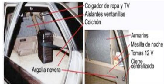
La principal dificultad de este mueble es que debe montarse dentro del coche. Es decir: no puede ensamblarse primero y después meterse dentro porque la bandeja original tiene un reborde enmoquetado para que lo que se deposita en ella no se caiga con los frenazos.
