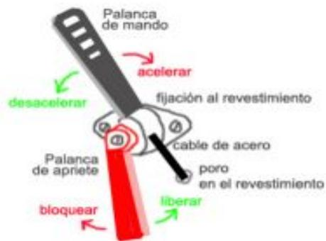
En el extremo superior, atornillamos el mando y lo que puede parecer a simple vista un tosco mando de calefacción, es lo más cómodo para ir siempre a 100 km/h en una recta interminable o siempre a 10 km/h en un atasco o para lo que se quiera. Pondremos otra palanca encima de ésta en el mismo tornillo para **graduar la dureza** del mando principal.
