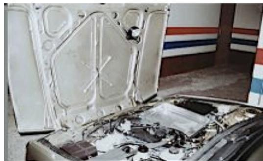
– Atornillando una **lámpara portátil en un nervio del interior del capó** puedes tener una buena fuente de iluminación tanto para cocinar como para el mantenimiento del motor o una emergencia.
