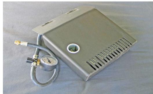
Así, cuando queramos usar el compresor sólo hay que conectar un *macho* del cable a la toma de corriente que elijamos (por ejemplo, en el salpicadero o en el maletero) y el otro *macho* a la *hembra* empotrada en el compresor.
