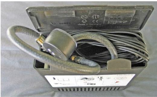
La solución que proponemos consiste simplemente en **cortar** el cable por su extremo interior y **ponerle un segundo macho** de conexión tipo *mechero* en el cabo suelto.
