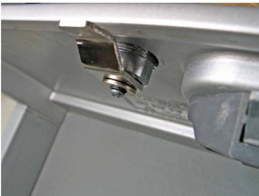
y, con la precaución de poner primero una arandela Grower de 20 mm  $\varnothing$
