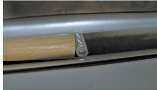
al que protegeremos por abajo **enfundándolo** con una manguerita transparente de 4 mm  $\varnothing$  de diámetro interior para que no arañe ninguna otra pieza ni nos lastime accidentalmente en caso de sacar el cajón.
