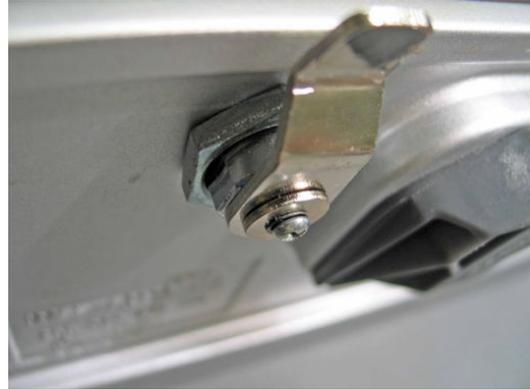
Finalmente, ya con todo instalado y el cajón puesto en sus carriles, se hacen las **pruebas de ajuste** y se pega si es necesario un **fieltro autoadhesivo** para que el cierre sea suave y tampoco vibre con los baches.
