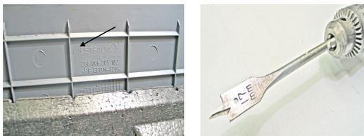
un orificio con la **broca de pala** de 17 mm  $\varnothing$ , que luego se afina con una lima de media caña.
