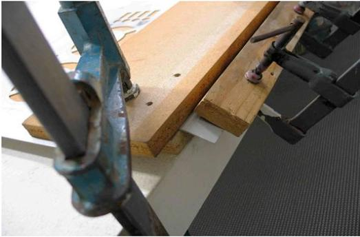
El remate final de cada pliegue se consigue con el **martillo de mecánico** golpeando a través de un taco de madera que se suele llamar *mártir* o *sufridera*.
