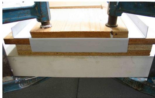
Para doblar las **dos últimas faldillas** es muy útil construirse una pieza con tablero aglomerado de poca calidad
