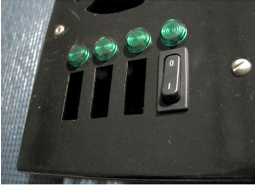
Como los **testigos** tienen el cable muy corto al comprarlos, podemos alargarlos un poco soldándole un par de segmentos del mismo conductor y luego aislando con cinta.
