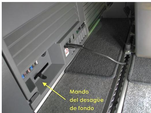
retiramos todo el líquido que pueda haber dentro del contenedor. Después **abriremos unos instantes el grifo** para que termine de salir el agua residual de las conducciones (hay que parar en cuanto se oiga a la bomba trabajar en vacío). No se conseguirá del todo, pero al menos con eso evitaremos verter por el interior de los muebles durante la colocación de la "T" más de lo admisible.
