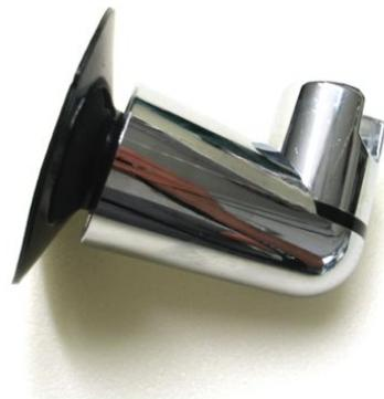
Al llevar ese dispositivo de **bloqueo**, cuando se retira el flexo de ducha, la válvula se cierra y no deja pasar el agua. Al menos teóricamente, porque nosotros *en garantía* tuvimos que sustituir la original, porque goteaba cuando el circuito quedaba bajo presión (cuando abría el grifo del fregadero, por ejemplo).
