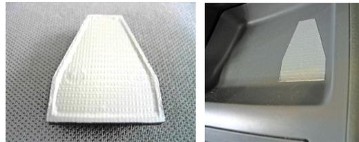
Luego basta poner una bolita de masilla *Arreglatodo Pattex* y presionar para que se expanda con el nivel encima, pero **sin llegar a aplastarla del todo**. Puesta la *furgo* en un sitio totalmente plano, con suaves movimientos buscamos el punto exacto donde marca *pendiente cero* y escora *cero*.
