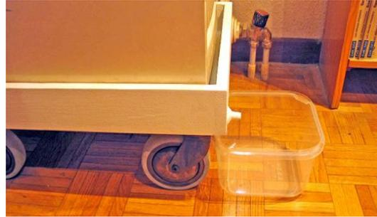
Otra solución es suspender en la parte inferior de la bandeja el **tupper**, donde no molesten las ruedas, y unirlo con el **racor loco** mediante una **gomita flexible**.
