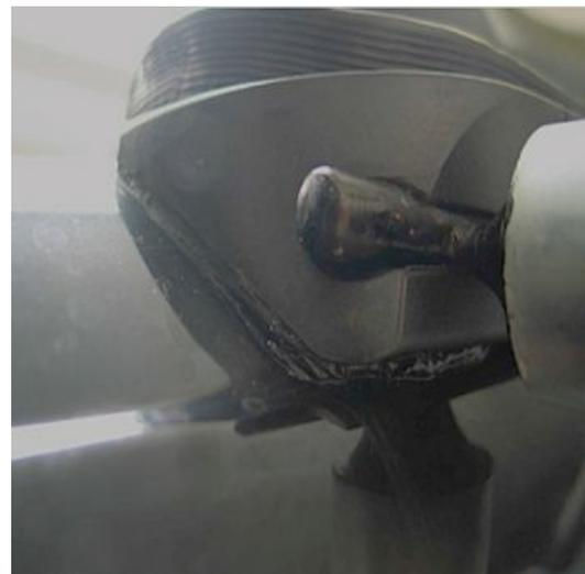
y llevarlas hasta los dos puntos deseados. Si antes se aplica un **spray de silicona**, de los que no manchan, se moverán muy fácilmente sin rozar.
