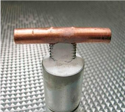
carenando el espacio entre roscas, su perímetro y los extremos del tubo de cobre.
