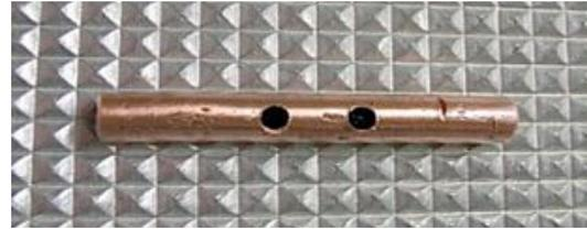
dos taladros, con la broca para metal HSS 3.75 mm  $\varnothing$ , en los que atornillaremos dos de *rosca-chapa*
