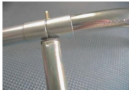
Los otros dos serán los encargados de permitir la **conexión rápida** y firme al carril del toldo, situado entre las puertas de la *furgo* y el techo elevable.
