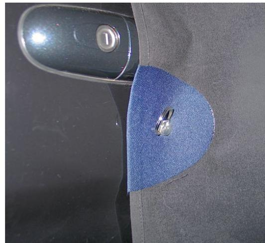
por donde luego insertaremos la ventosa *Westfalia* por un lado y su anilla de bloqueo y despegado por otro. Las 6 que hemos usado son las que nos han sobrado del *set isotérmico* de parabrisas/ventanillas delanteras, porque sólo le tenemos puestas dos a cada pieza.
