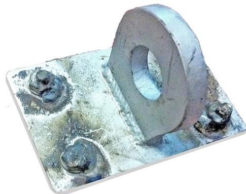
con la precaución de dar unos puntos de **soldadura para evitar el giro de las tuercas** o de las cabezas de los tornillos.
